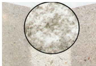
Stabiliteit van binnen uit. De foto laat het in detail zien: het homogene mengsel van gips en papiervezels zorgt voor stabiliteit van binnen uit.
